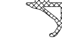
DP1500 Guarnizione di battuta inserimento a mano, interna ed esterna materiale: EPDM
