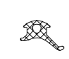
DP2270 Guarnizione di battuta inserimento a mano, esterna compensazione di pressione materiale: EPDM
